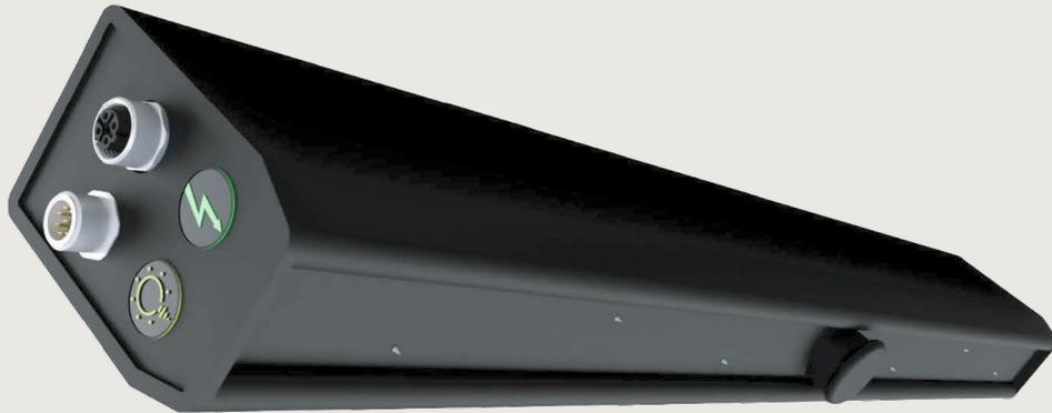
Die Weitbereichselektrode ermöglicht optimale Entladeleistungen von 300 mm bis 1300 mm. Automatische Regelung, integrierter Abstandssensor und externe Bedienbarkeit gehören zum Standard.
